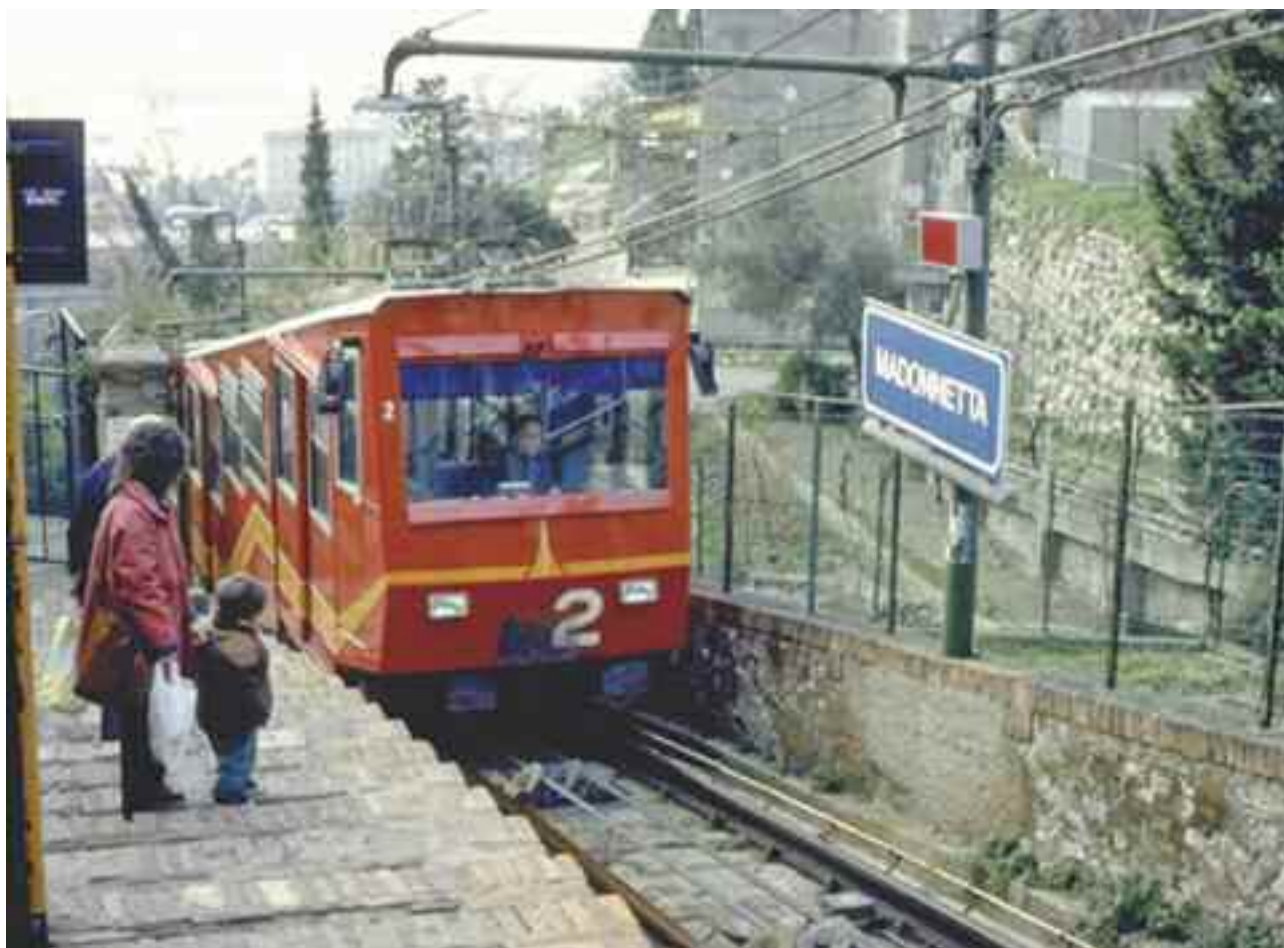
foto 3 – la fermata della Madonnetta: da notare la speciale costruzione inclinata della cabina
