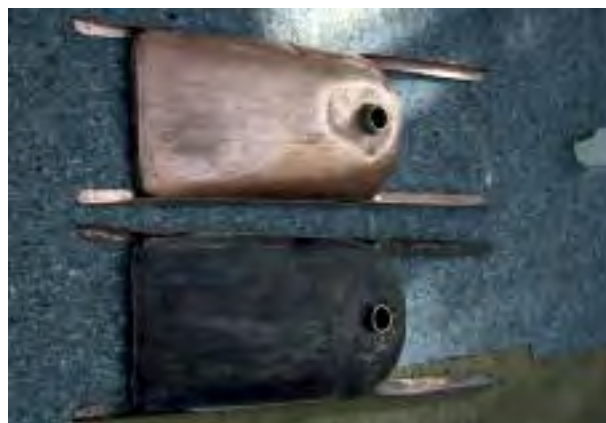
La pulizia dei serbatoi ausiliari sopra le ali
