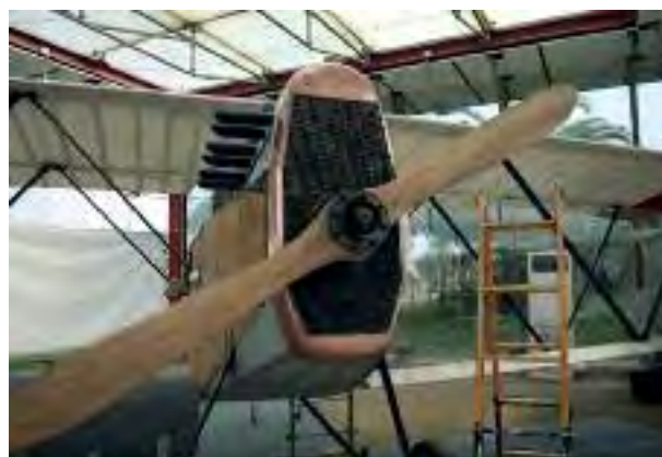
L'elica preparata ed il radiatore ripulito
